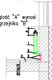
Schemat podłączenia grzejnika
